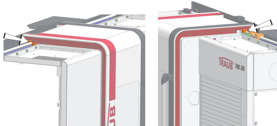
TNL20 Aut. work area door Xcenter 3
