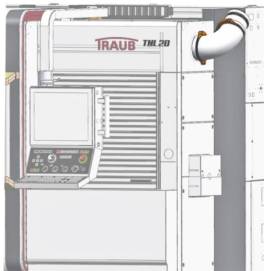
Mechanische Vorbereitung für zentrale und für dezentrale Absauganlage mit Absperrklappe, bzw. mit Brandschutzanlage
