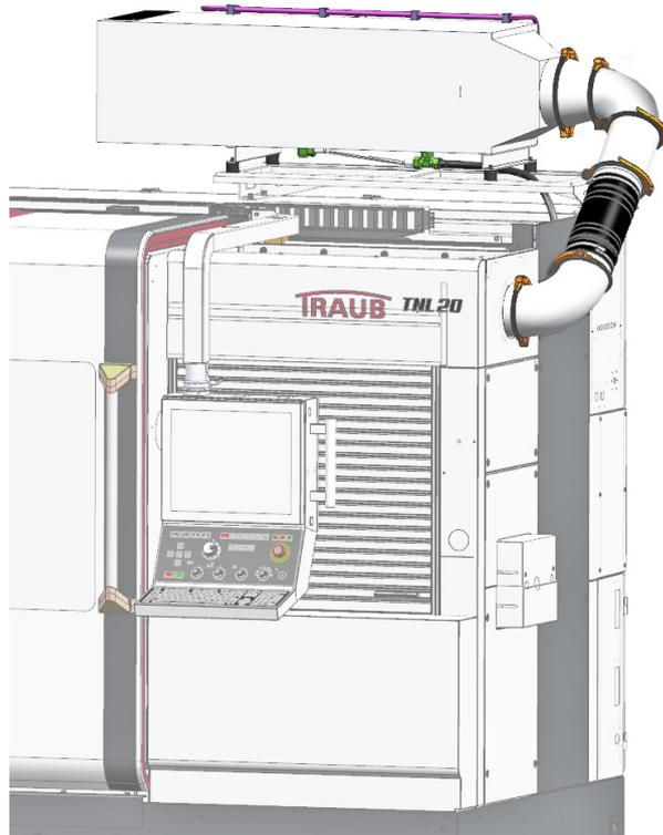
Anbau dezentrale Absauganlage mit Brandschutzanlage, bzw. Absperrklappe
