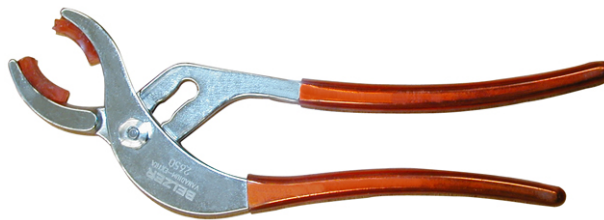
Beispiel: Spezial-Zange zum Anziehen der Energie- und Geberanschlüsse an den Motoren
